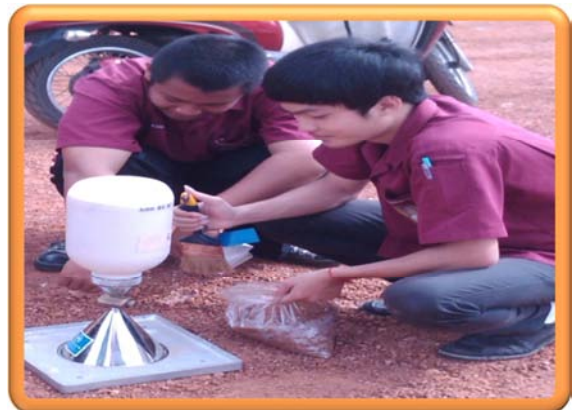
เก็บดินใส่ถุงและหาปริมาตรของหลุม โดยวิธีการแทนที่ด้วยทราย
