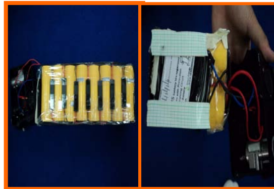
การต่อแบตเตอรี่ของรถจักรยานไฟฟ้า
