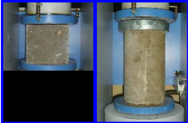
การจัดวางแท่งทดสอบรูปทรงลูกบาศก์ และลูกทรงกระบอกเข้าเครื่องทดสอบกำลังคอนกรีต
