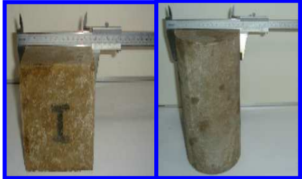
วัดขนาดมิติของแท่งทดสอบรูปทรงลูกบาศก์และรูปทรงกระบอก
