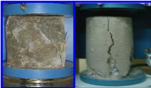
แท่งทดสอบรูปทรงลูกบาศก์ และทรงกระบอกถึงจุดประลัย
