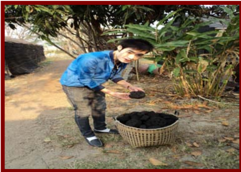
ถ่านอัดแท่งจากเศษวัสดุที่ใช้เพาะเห็ดแล้ว
