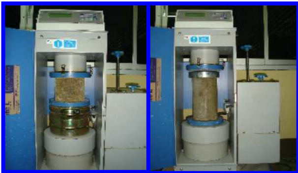
การจัดวางแท่งทดสอบปูนทรงลูกบาศก์ และทรงกระบอกเพื่อรองรับแรงอัด
