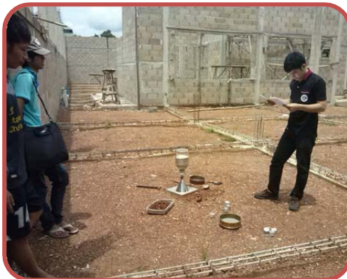
การทดสอบความหนาแน่นของดินในสนาม และทำการบันทึกผลการทดสอบ
