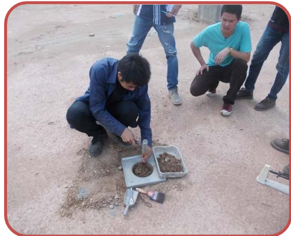
การเก็บตัวอย่างดินที่ได้บดอัดแล้ว เพื่อนำไปหาปริมาณความชื้น
