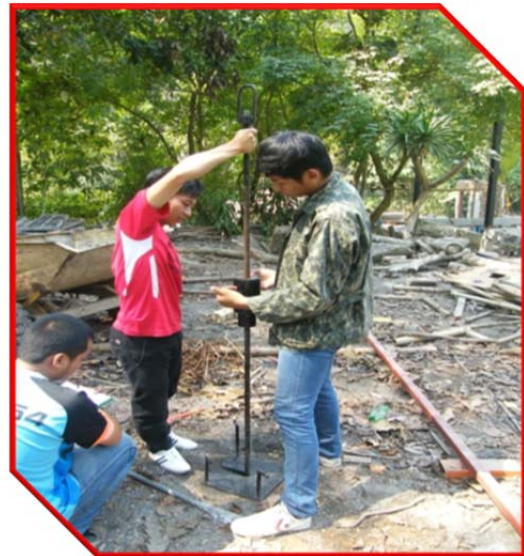
การทดสอบการรับน้ำหนักของชั้นดิน โดยวิธี kunzel stab
