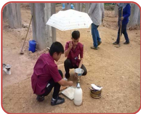
การทดสอบความหนาแน่นของดินในสนาม
